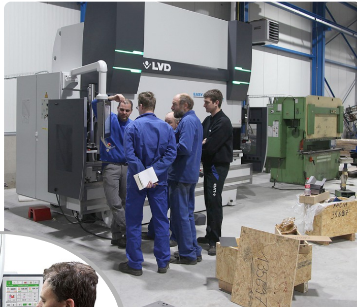
Bovenaan: de hightech Easy-Form 135/30, inclusief meetsysteem, vervangt twee bestaande machines en werd geleverd met speciale adapters voor de bestaande gereedschappen. Een LVD-technicus is bezig met het geven van de opleiding Links: de Dyna-Press ... heel licht, zeer snel en mobiel
